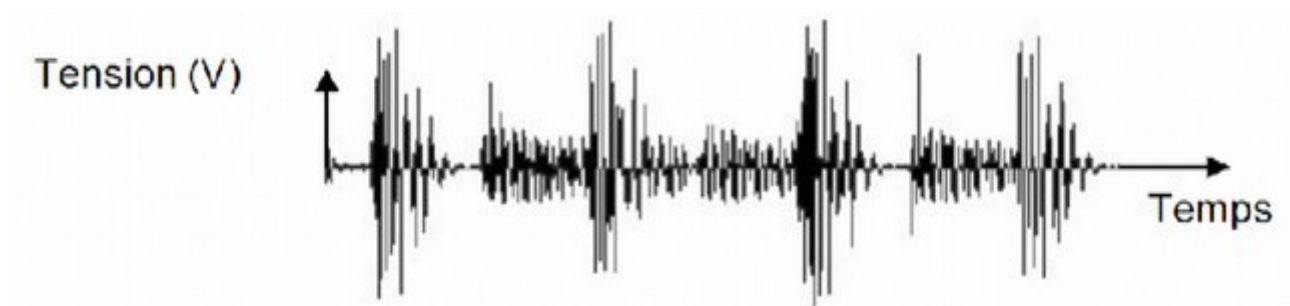
Figure 2 : exemple de signal analogique (microphone d'une guitare électrique)
